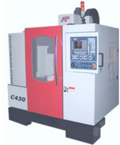
Centre d'Usinage CN 3-4 axes
