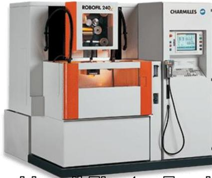
Machine d'Electro-Erosion à fil Charmilles 240 CC
